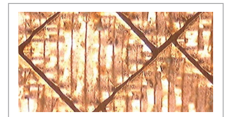
Mit bis zu 110 µm Tiefe bei 914 µm Querdiagonale realisiert XtremeEngraving sehr große Schöpfvolumina.
