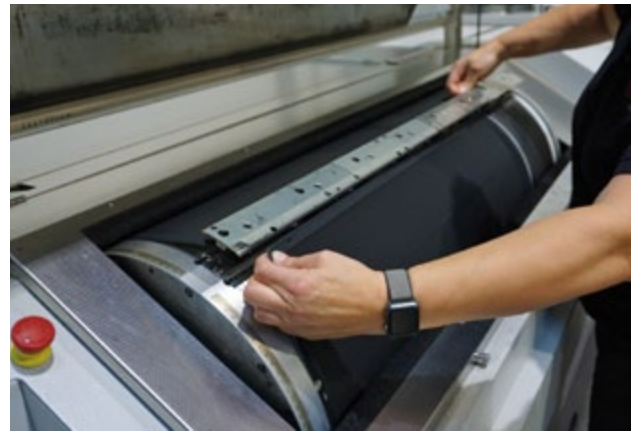
Das Einspannen einer Elastomer-Lackplatte für die Direktgravur
